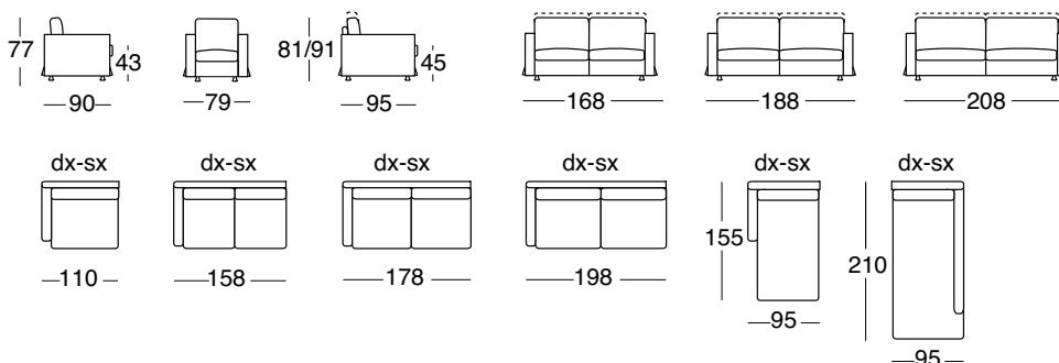
**IT** Struttura portante in tubolare di acciaio garantito 10 anni. Imbottitura in Poliuretano espanso a quote differenziate con ovattatura in fibre acriliche. Molleggio seduta in acciaio armonico. Cuscini seduta e schienale in Poliuretano espanso a quote differenziate rivestiti in falda acrilica termolegata. Elementi completamente sfoderabili. Lo schienale è dotato di un semplice meccanismo che permette il sollevamento manuale del cuscino restando seduti.
