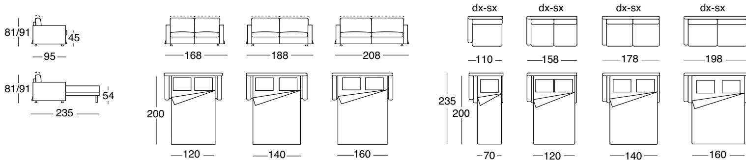
**IT** Divano trasformabile in letto completamente sfoderabile. Struttura portante in tubolare d'acciaio. Meccanica estraibile con rete elettrosaldata e plastificata. Imbottitura in Poliuretano espanso con ovattatura in fibre acriliche. Cuscini seduta e schienale in Poliuretano espanso a quote differenziate rivestiti in falda acrilica termolegata. Materasso H. cm. 13 a molle. Su richiesta il materasso può essere fornito in Polilatex.
